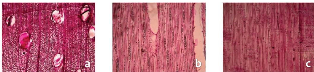
Figura 7. Juglans neotropica. a. Fotografía plano transversal, b. plano tangencial, c. plano radial.
