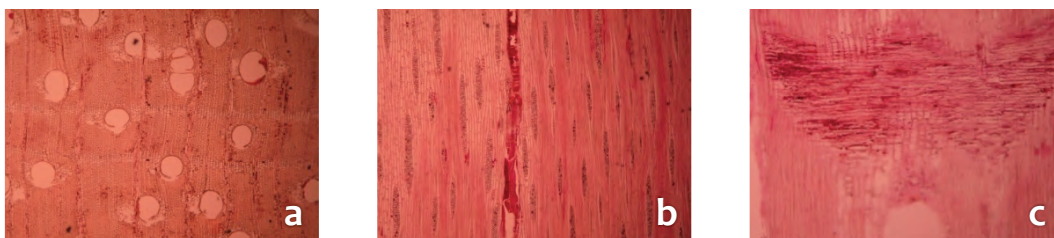
Figura 5. H. oblongifolia . a. Fotografía plano transversal, b. plano tangencial, c. plano radial.
